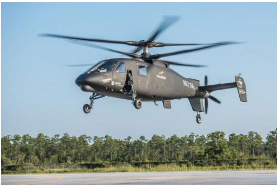
Вертолет S-97, так же как вертолеты Sikorsky–Boeing SB-1 Defiant, спроектирован по соосной схеме с жесткими несущими винтами и дополнительным толкающим. Впервые такая конфигурация была опробована в 1970-е гг. на вертолете Sikorsky ХН-59А, достигшем в горизонтальном полете скорости, равной 440 км/ч. Вертолет ХН-59А оказался сложным в пилотировании, обладал высокими уровнем вибраций, а также расхода топлива.
